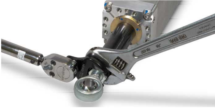
图 4.3: (图为 CSWX) 对于圆杆, 在将附件、连杆或负载连接到电动缸上时, 用扳手固定住推力杆末端的平面。使用扭矩扳手将连接杆的一端拧紧到执行机构的螺纹连接点上。表 4.2 中提供的扭矩值
